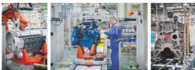
Производство средних рядных двигателей ЯМЗ-530
